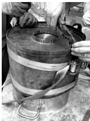
Photo 11: pliage progressif à la pince
