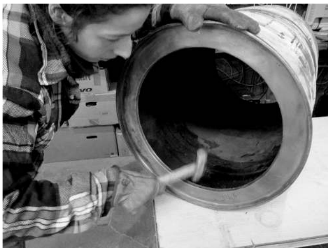
Photo 7: Ajustement du trou de la gamelle au marteau de bidonnier
