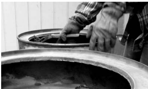
Photo 6: Pliage à la pince multiprise pour un trou ajusté à la taille de la gamelle
