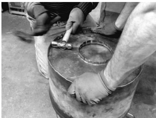
Photo 12: Finition au marteau
