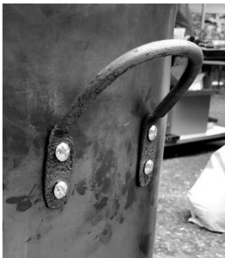
Photo 10: Poignée forgée de charme avec les boulons coté esthétique
