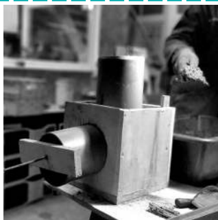
Photo 4: Assemblage du coffrage et moulage du foyer
