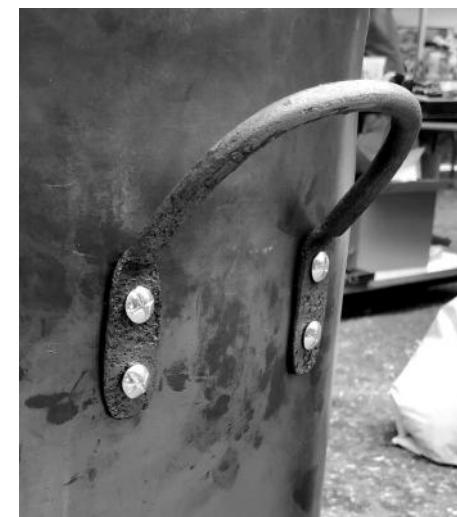
Photo 10: Poignée forgée de charme avec les boulons coté esthétique
