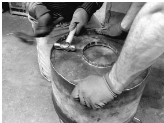
Photo 12: Finition au marteau
