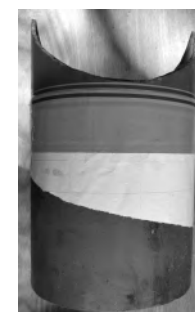
Photo 1: Gueule de Loup dans un tube en PVC
