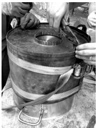
Photo 11: pliage progressif à la pince
