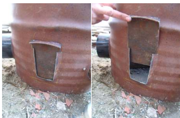
Zone à réserver pour l'évacuation du sable. Fais-en une de chaque côté.
