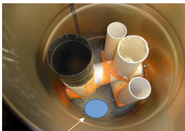
Zone à réserver pour l'évacuation du sable. Fais-en une de chaque côté.
