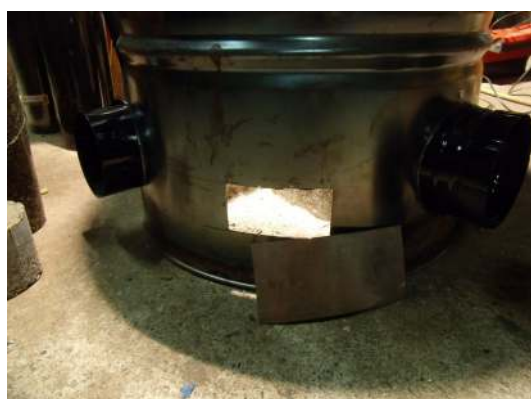
Trappe simple qui sera maintenue par 2 boulons placés avant coulage, comme sur le bidon bleu ci-dessus.
