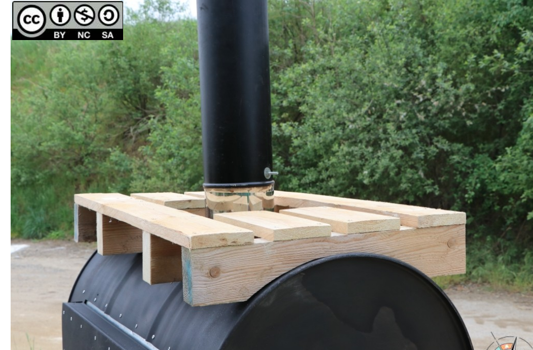
Fabrication d'une étagère pour poser les plats et pizza avant d'enfourner
