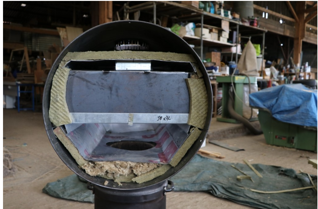
Mise en place de l'isolant et bourrage avec les chutes
