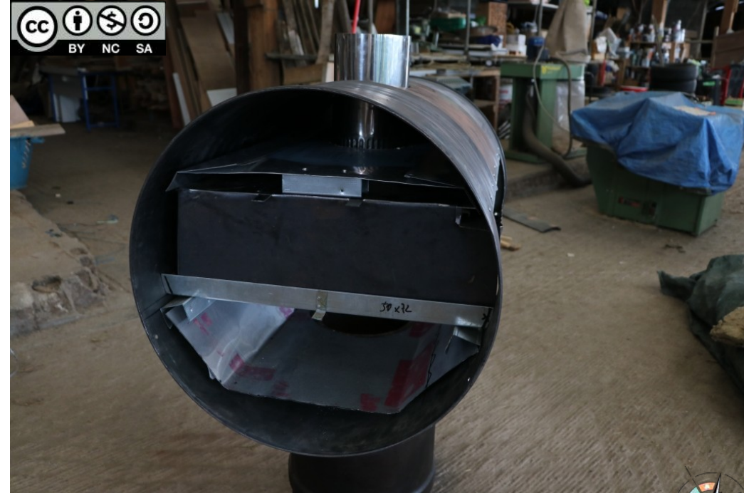
Découpe et perçage rail placo passage fumées et rivetage sur plaque offset plié et mise en place tube évacuation
