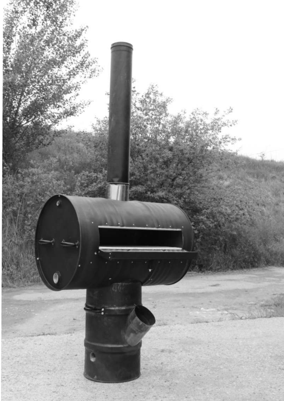
Le four fini avec conduit évacuation complet et brûleur (problème de fermeture porte résolu depuis)
