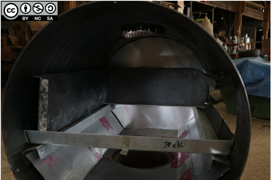
Découpe et pliage tôles coté et mise en place (une seul sur les deux sur la photo pour plus de lisibilité)
