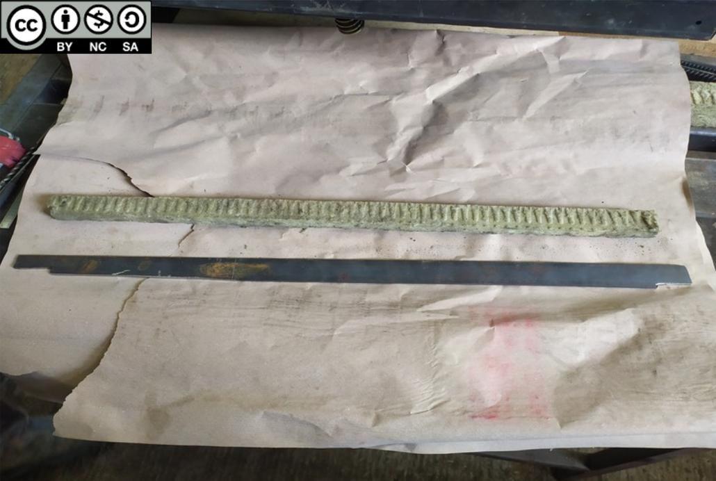
Découpe fer plat et laine de roche, ajustement du fer plat à l'espace laissé entre le té et le bidon côté porte
