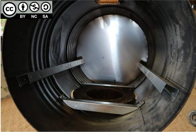
Découpe trou évacuation et brûleur, fixation poignées, mise en place fond isolant, fixation des cornières du brûleur et des rails de tenu d'isolant.
