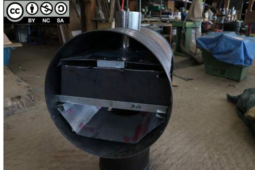
Découpe et perçage rail placo passage fumées et rivetage
