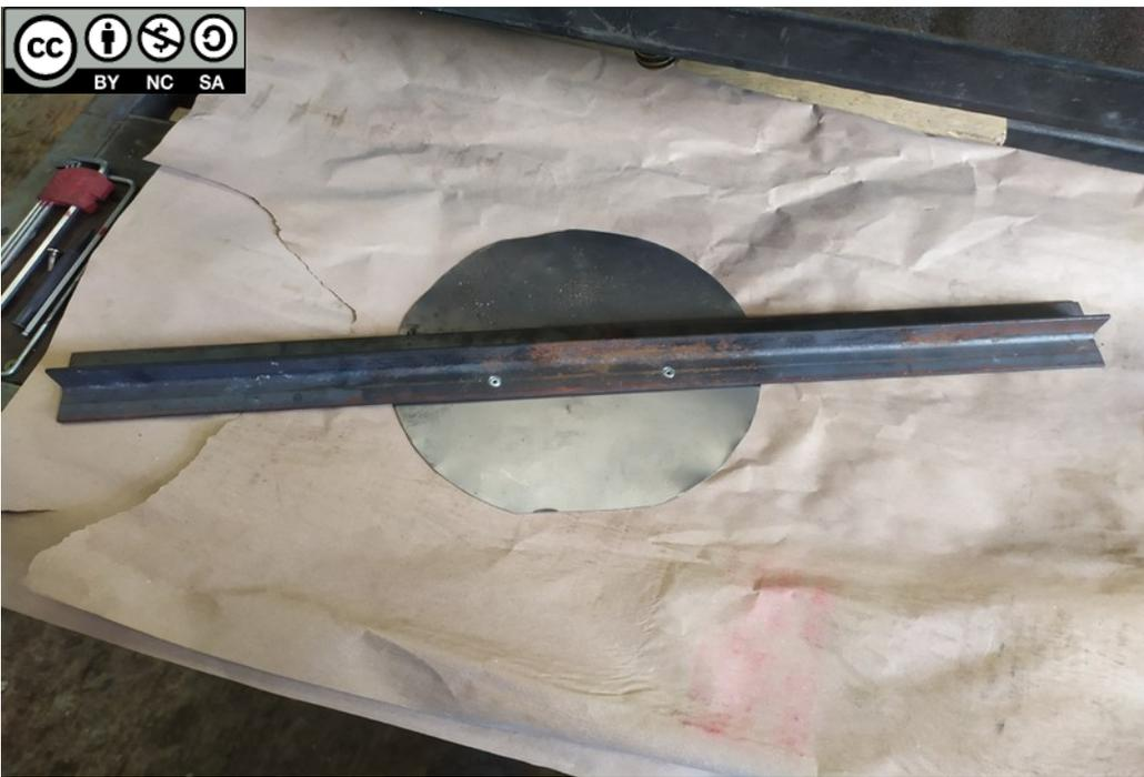
Découpe des Tés de support et assemblage avec le déflecteur (rivets inox et perçages fraisés dans le Té)
