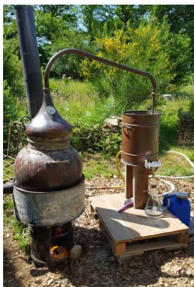
Cuiseur adapté à un alambic – Cuve de 50L portugaise en cuivre – débit vapeur jusqu'à 10L/h
