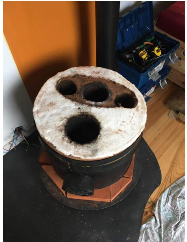
A droite, pose de la laine céramique qui assure l'étanchéité entre les 2 blocs.
