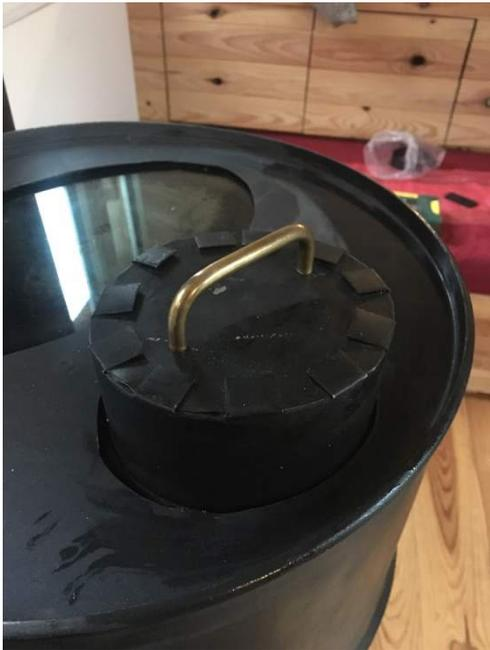
A gauche, bouchon, fait avec tuyau 150 découper et riveter pour être transformé en 130
