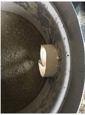
J2 : Découpage du cendrier + évac fumée : ouvertures dans le bidon, rivetage du tuyau 140 pour le transformer en 130 pour le cendrier.
