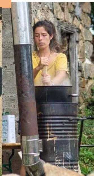
Nous fabriquerons des poêle de type "rocket", qui permettent de cuisiner au feu de bois avec d'excellents rendements et une combustion très propre. Le brûleur est adaptable à plusieurs modules (casserole, poêle, galetières, chauffe eau, four, alambic etc...). Il s'agit d'un modèle de poêle diffusé par l'association Oxalis. Lors d'une formation, nous proposons la fabrication des modules casserole, poêle et galetières.
