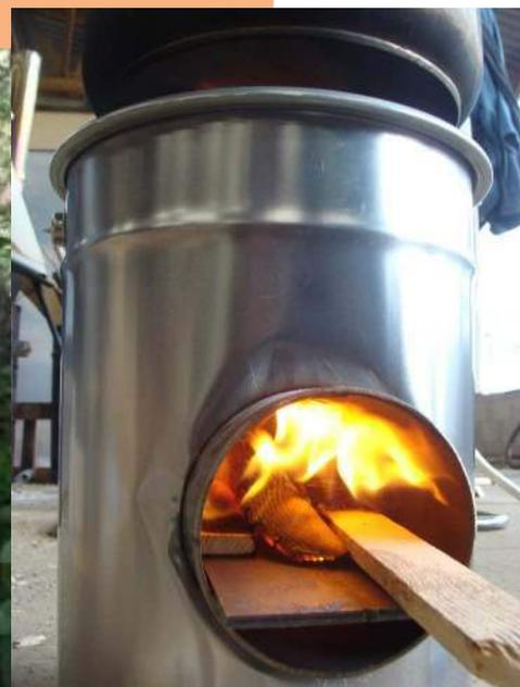
Nous fabriquerons des petits cuiseurs qui permettent de cuisiner au feu de bois avec de bons rendements et une combustion propre. La fabrication de ce modèle de taille réduite est une bonne occasion de s'initier à la cuisson au bois et de fabriquer son premier « Rocket » ! Une fois fabriqué, il est possible d'y poser différents types de casseroles ou poêles et de cuisiner pour 3-4 personnes avec du bois glané çà et là. Ce poêle est facilement mobile (camping)
