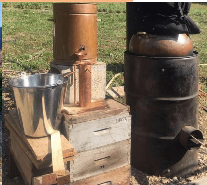
Nous fabriquerons des poêle de type “rocket”, qui permettent de chauffer au feu de bois avec d’excellents rendements et une combustion très propre. Le brûleur est adaptable à plusieurs modules (casserole, poêle, galetières, chauffe eau, four, **alambic** etc... ). Il s’agit d’un modèle de poêle diffusé par l’association Oxalis. Lors de cette formation nous fabriquerons un module pour chauffer un alambic pour distiller des huiles essentiels
