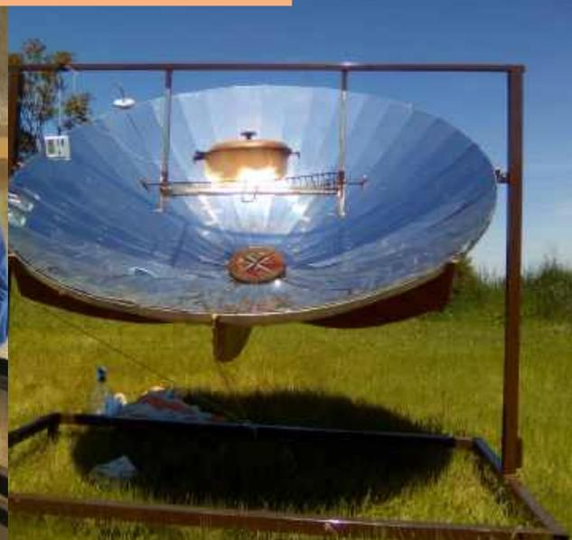
Ce cuiseur solaire conçu par AlterEco30 est notre cuiseur préféré dès que le soleil brille : il permet de cuisiner tout type de plats sans rien consommer ! Sa grande taille (1m70 de diamètre) lui permet d'atteindre jusqu'à 220°C en son point focal. Cela nécessite un espace dédié en extérieur suffisamment grand, si possible près de votre cuisine pour une utilisation quasi quotidienne en été !
