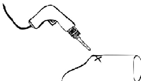
5/ remettre le tube puis faire passer la vis et serrer l' écrou dans le tube. Si la vis est trop loin du trou, on peut sans abîmer le filetage légèrement tordre la tôle
