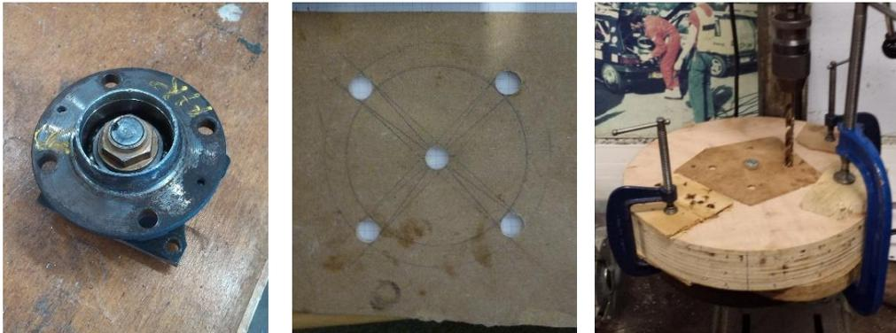
Figure 30 : Repérage des fixations du moyeu sur les flasques
