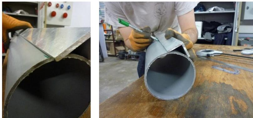
Figure 25 : Marquage des pales sur le tuyau 2
