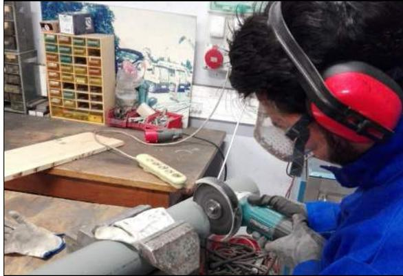
Figure 23 : Découpe du tuyau à la scie circulaire
