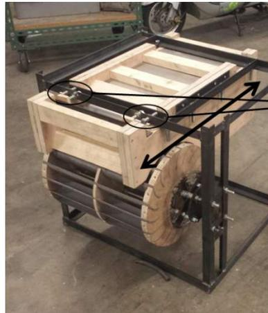
L'action sur ces vis permet le réglage horizontal de l'injecteur
