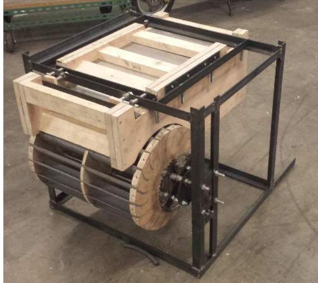
Figure 1 : Turbine Banki construite par l'association
