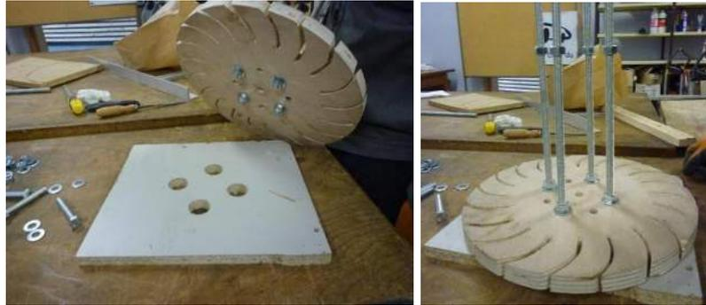
Figure 33 : Mise en place des tiges filetées sur les flasques
