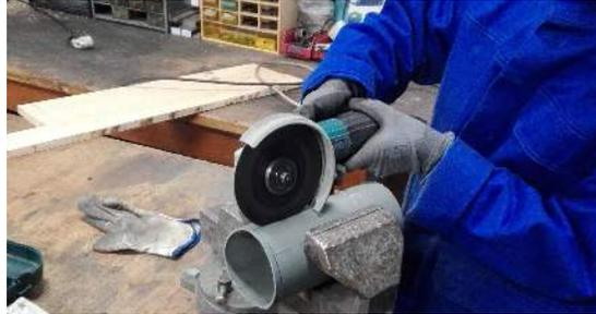
Figure 26 : Découpe des pales à la scie circulaire
