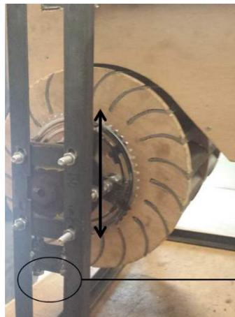
L'action sur ces 2 vis permet le réglage en hauteur de la roue
