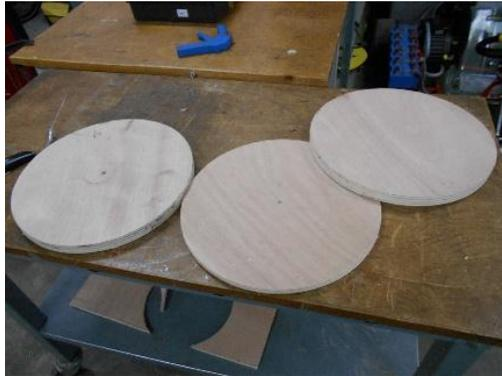
Figure 29 : Flasques de diamètre D découpées
