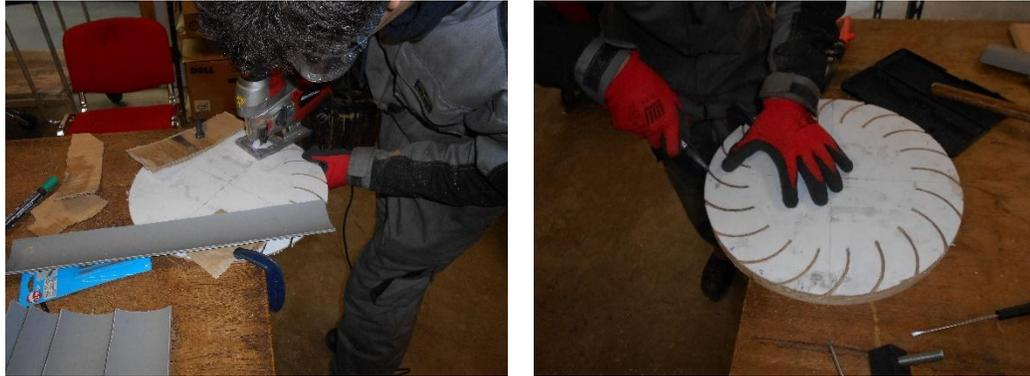
Figure 31 : Traçage des encoches sur les flasques
