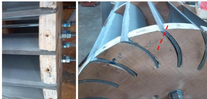
Figure 36 : Trous pour la fixation des pales
