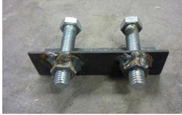
Figure 56 : Soudure des boulons
