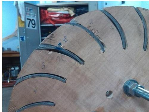
Figure 32 : Flasques numérotées avec les pales insérées
